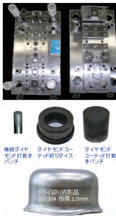
図3 ポロンドープダイヤモンド膜をコーティングしたパンチとダイならびに成形品
